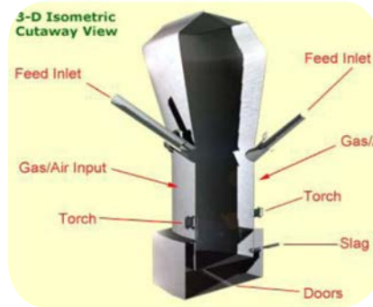
شکل (۳۳) شماتیک راکتور گازساز پلاسما
